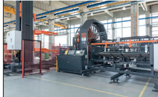
Сварочные машины для изготовления армокаркасов для колец и ж/б труб
