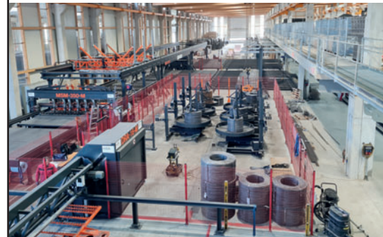
Сеточные машины для изготовления армосеток для изготовления прямоугольных водопропускных труб, сборных железобетонных элементов и нестандартных сеток
